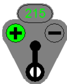
Рисунок 26 – Нормальное положение стрелочного коммутатора
