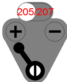
Рисунок 29 – Отсутствие контроля положения на спаренной стрелке
